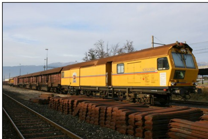
Train meuleur de rails (Scheuchzer S.A.)
